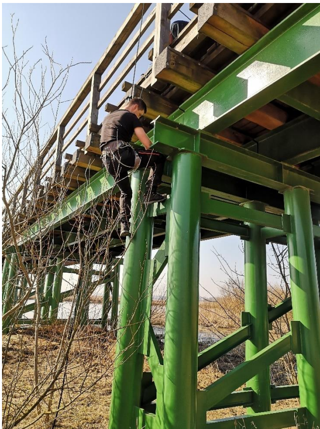
Fot. 28. – Badania połowe długości słupopali metodą niskonaprężeniową – filar nr 2
