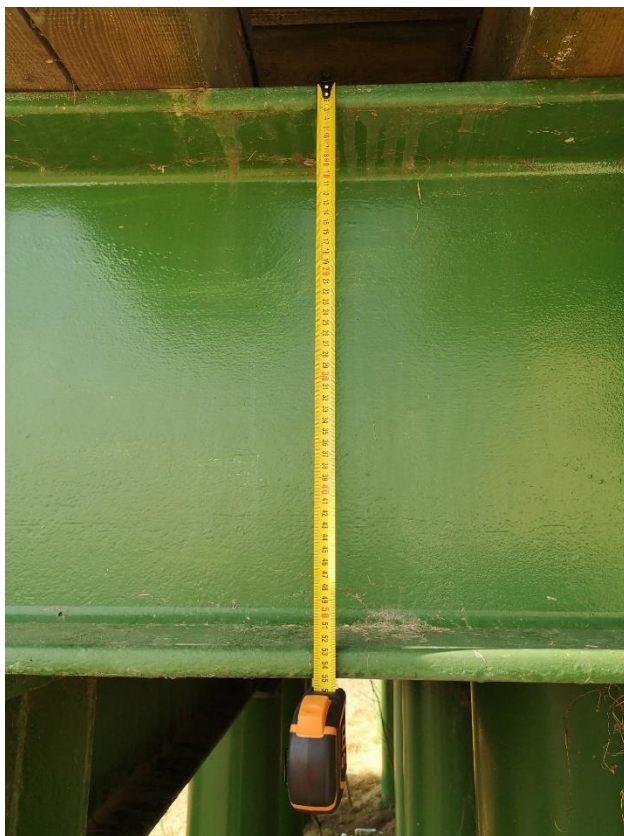
Fot. 13. – Pomiar geometrii podłużnicy stalowej pomostu
