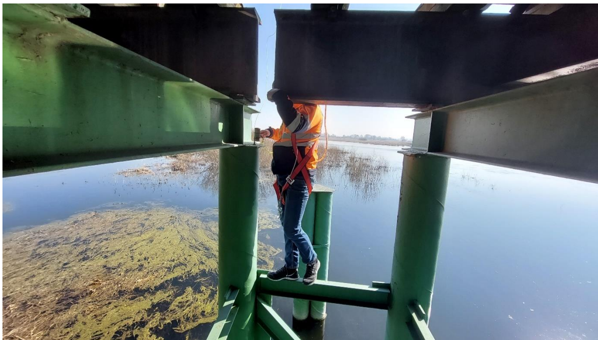
Fot. 26. – Badania połowe długości słupopali metodą niskonaprężeniową – filar nr 4
