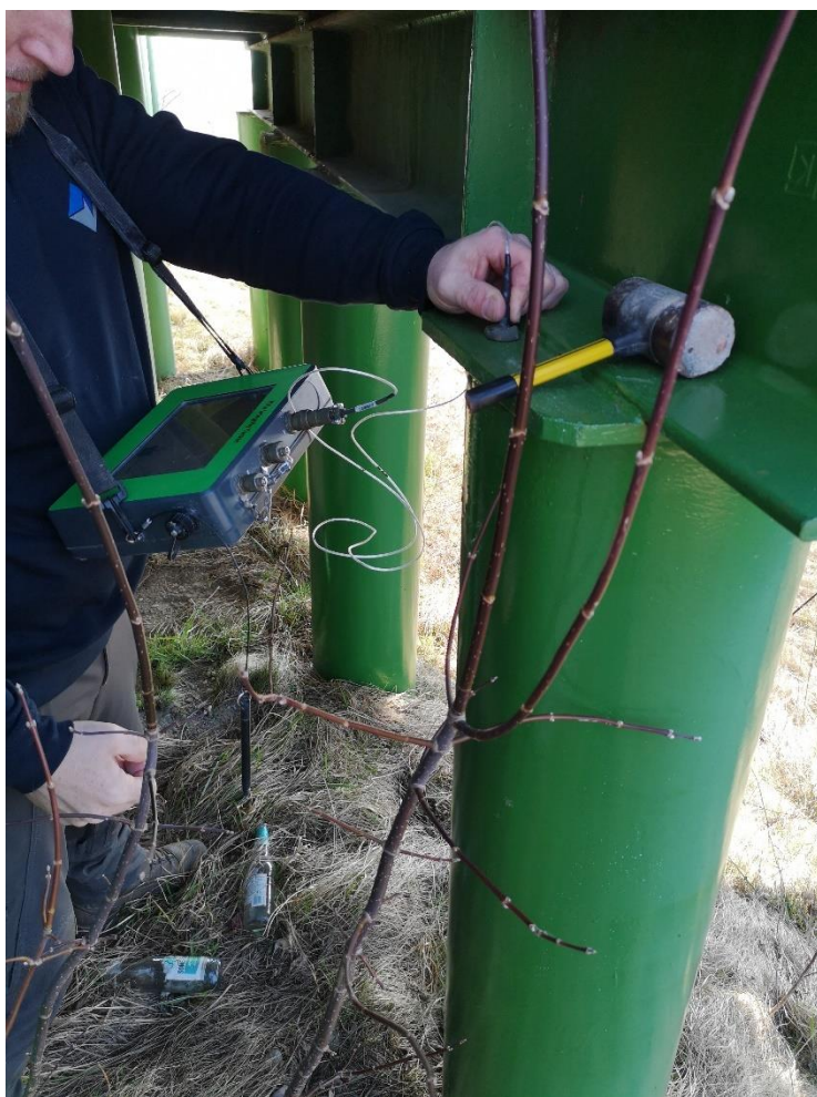
Fot. 27. – Badania połowe długości słupopali metodą niskonaprężeniową – filar nr 2
