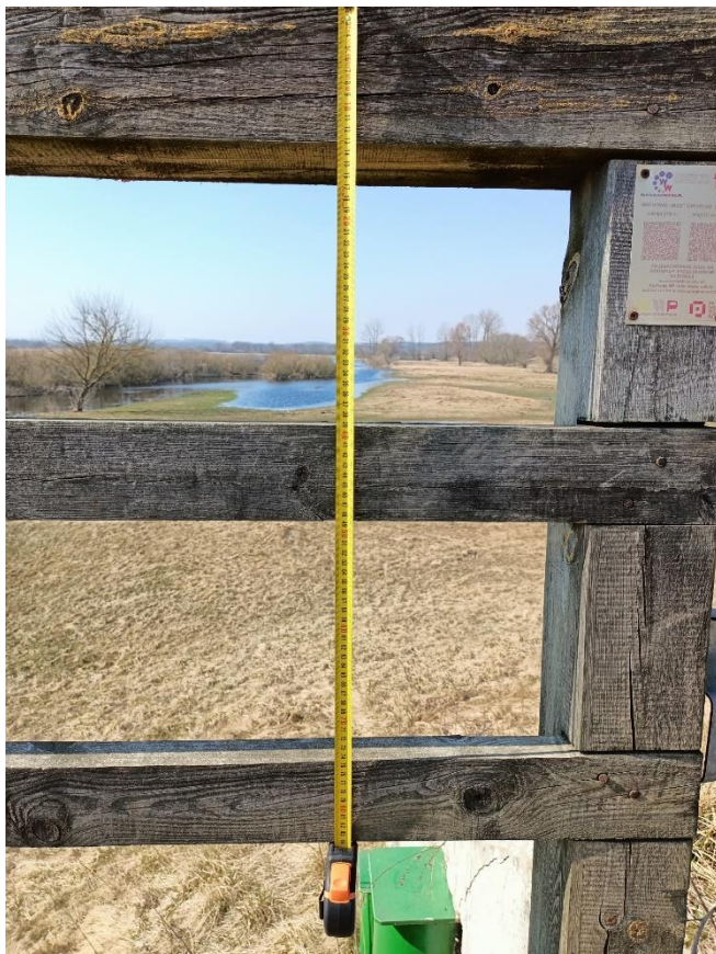
Fot. 19. – Pomiar elementów balustrady drewnianej
