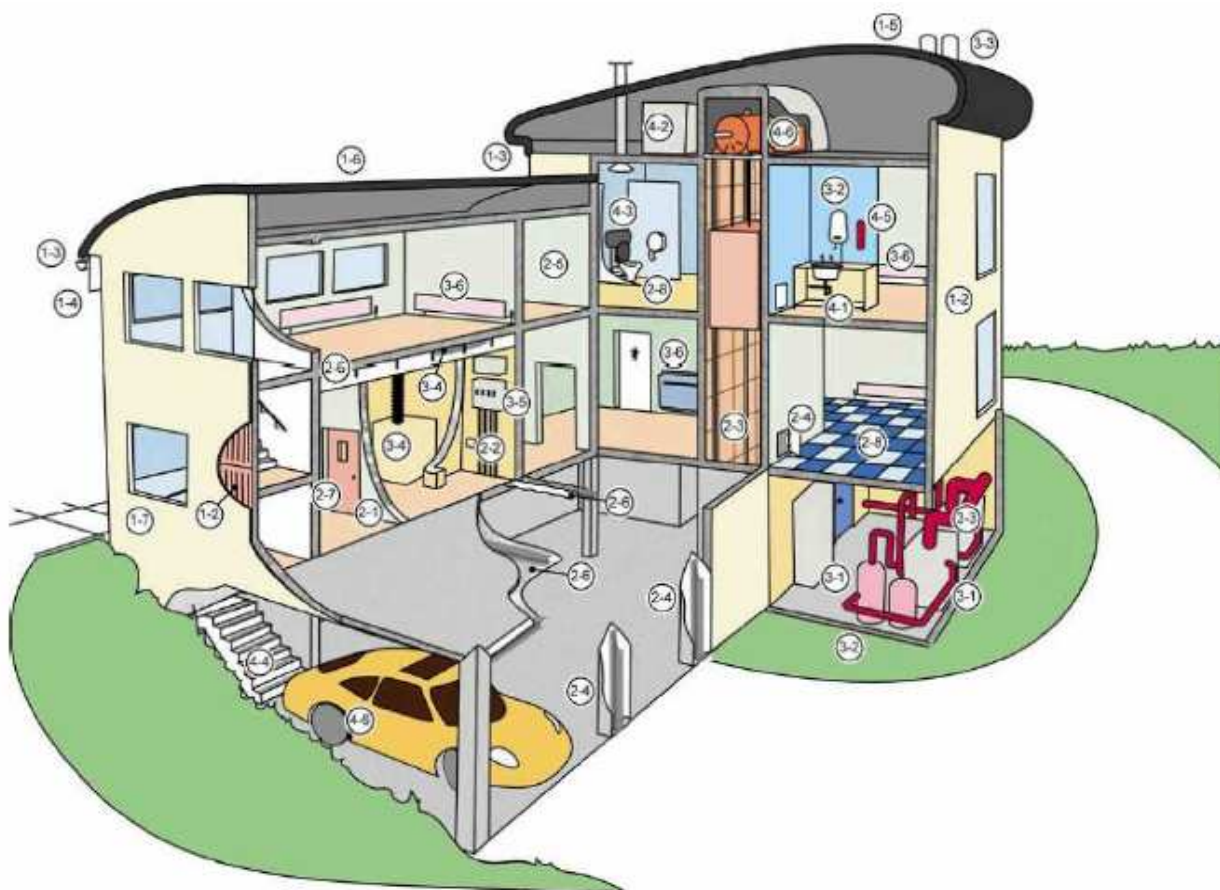
Rycina 3 Typowe lokalizacje materiałów zawierających azbest w budynku mieszkalnym
