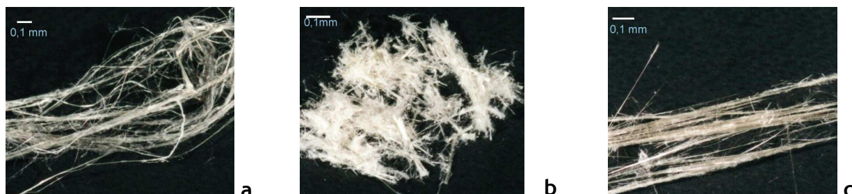
Rycina 1 Długowłóknisty azbest chryzotylowy praktycznie nie zawierający zanieczyszczeń (a), chryzotylowy azbest krótkowłóknisty zanieczyszczony talkiem (b) i azbest amozytowy (c)
